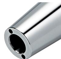
**Nachträgliches Erodieren von 2 Kühlkanalbohrungen**
