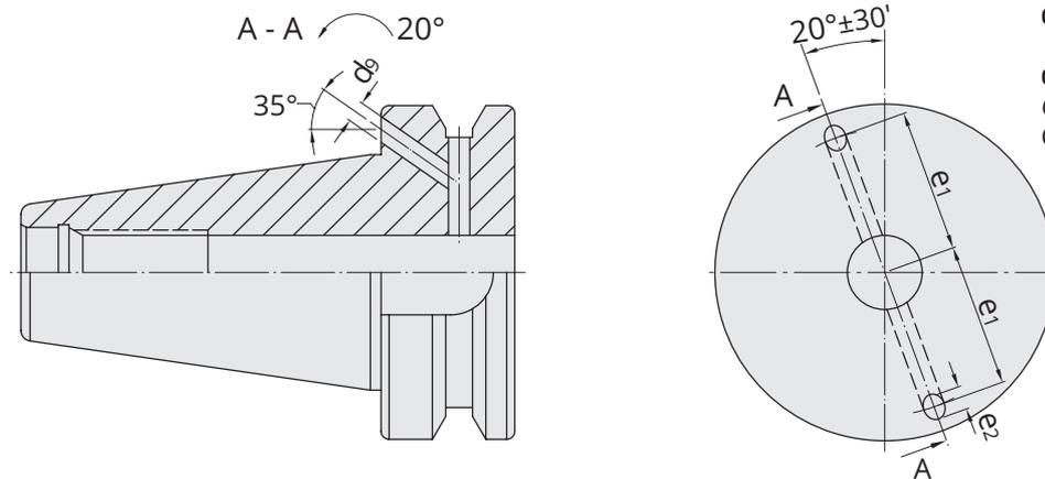
**Werkstoff:** Legierter Einsatzstahl mit einer Zugfestigkeit im Kern von min. 950 N / mm<sup>2</sup>. Einsatzgehärtet HRC 60 ± 2 (HV 700 ± 50), Härtetiefe 0,8 mm ± 0,2 mm, brüniert und präzisionsgeschliffen.
