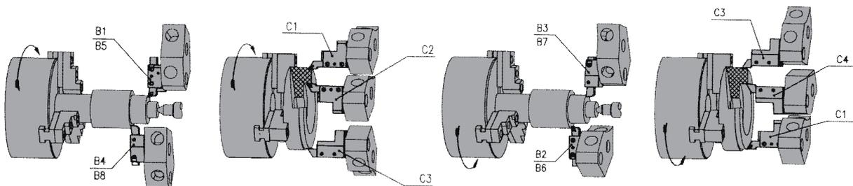
Einsatz von Werkzeughaltern bei linker Spindeldrehrichtung
