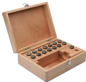
Präzisionsspannzangensätze im Holzkasten
